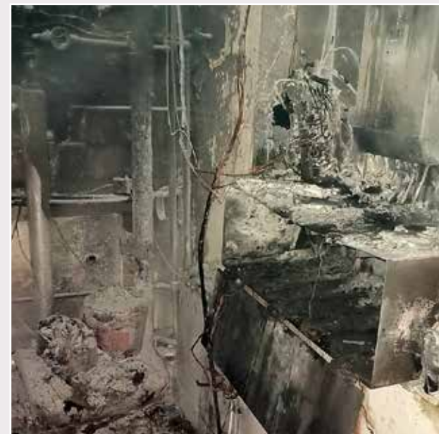
Požár bateriového uložení v rodinném domě
